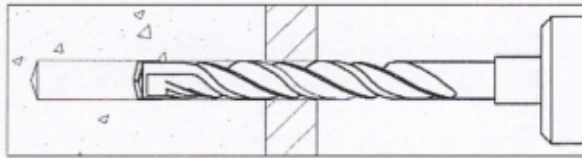
Рис. 3. Способ установки дюбелей закручиванием
